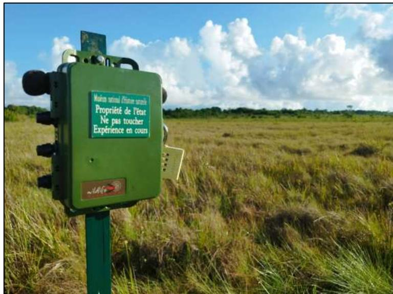
Figure 25 : Dispositif Song Meter 4 (SM4) installé dans une savane sèche, fixé sur un piquet à 1,50 m au-dessus du sol. © Méryl Gervot
